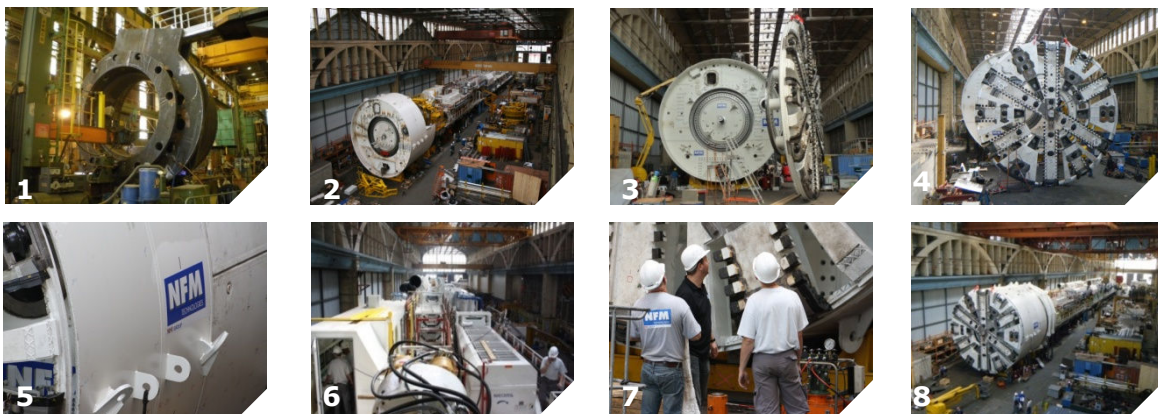
Le tunnelier a été fabriqué, monté et testé dans les ateliers NFM du Creusot : 1/ Opération de mécanosoudage 2/ Tunnelier en cours de montage 3-4/ Assemblage de la tête de coupe 5/ Ailerons de stabilisation sur le bouclier frontal 6/ Première remorque, avec cabine de pilotage 7/ Personnel NFM Technologies 8/ Machine assemblée dans l'usine.
